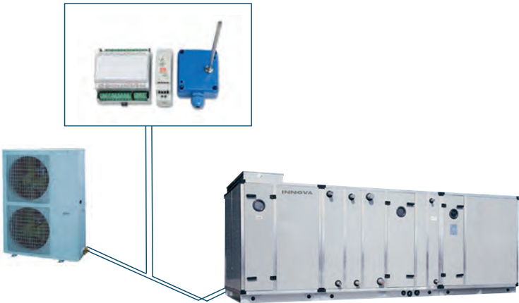
Rysunek podładowy podłączenia zestawu AHU KIT do agregatu skraplającego przy centrali wentylacyjnej.
