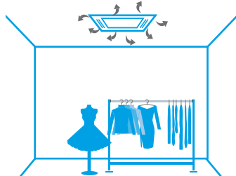
Rozkład powietrza z zabrudzonym filtrem
